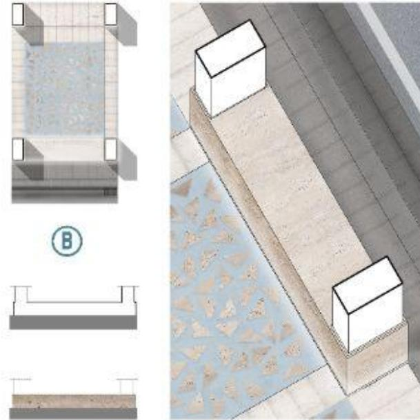
Dettaglio - Panca lunga (da pilastero a pilastro)
